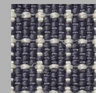
Obermaterial aus Vectran®: enorm reiß- fest, geringes Gewicht und abriebfest
